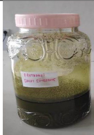
Gambar 6. Proses maserasi etanol 96% selama 3x 24 jam
