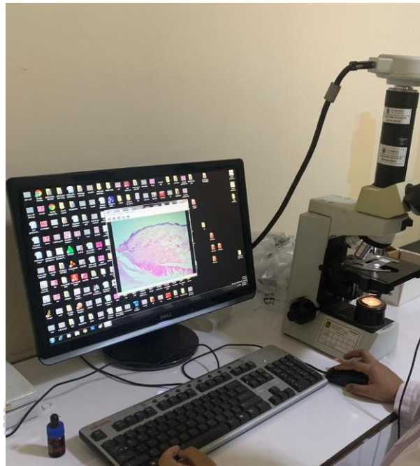
Gambar 13. Pengamatan sediaan mikroskopis menggunakan mikroskop elektrik (Optilab) pada pembesaran 400x
