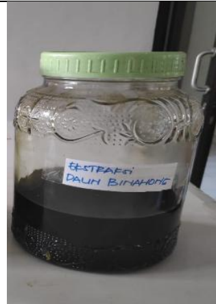
Gambar 6. Proses maserasi etanol 96% selama 3x24 jam
