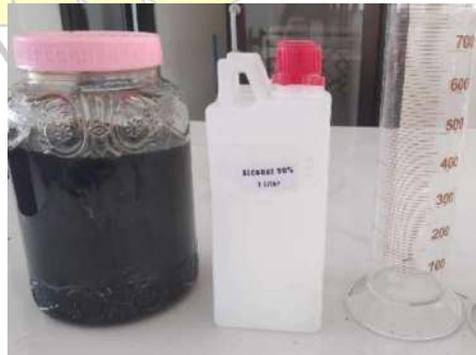
Ekstrak biji kelor yang dimaserasi etanol 96% selama  $3 \times 24$  jam
