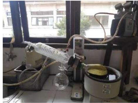
Evaporasi dengan *rotary vacuum evaporator*
