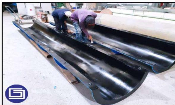
Gambar 2. 17 Bekesting dengan *fiberglass*
