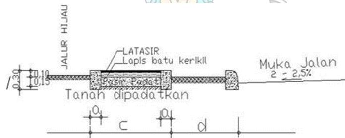
Gambar 2.9 konstruksi trotoar permukaan aspal
