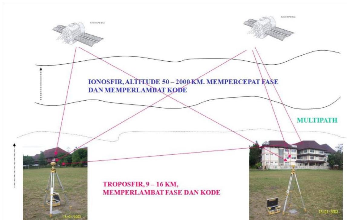
Gambar 2.13 Perjalanan Sinyal *GNSS/GPS*
