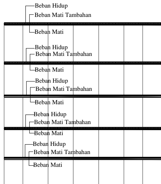
Gambar 2. 17 Kondisi Tahap 5 Analisis Konstruksi Bertahap
