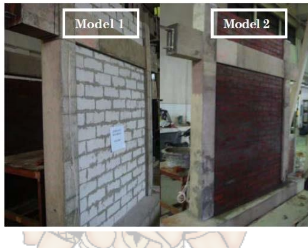
Gambar 2. 15 Model eksperimen dinding pengisi bata ringan dan bata konvensional Sumber: (Imran & Aryanto, 2009)
