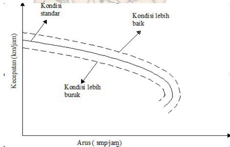
Gambar 2.4 Hubungan kecepatan dan arus pada kondisi standard dan bukan standard
