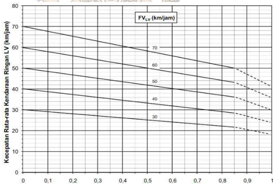
Gambar 2.5 Kecepatan sebagai fungsi dari Q/C untuk jalan 4/2 UD
