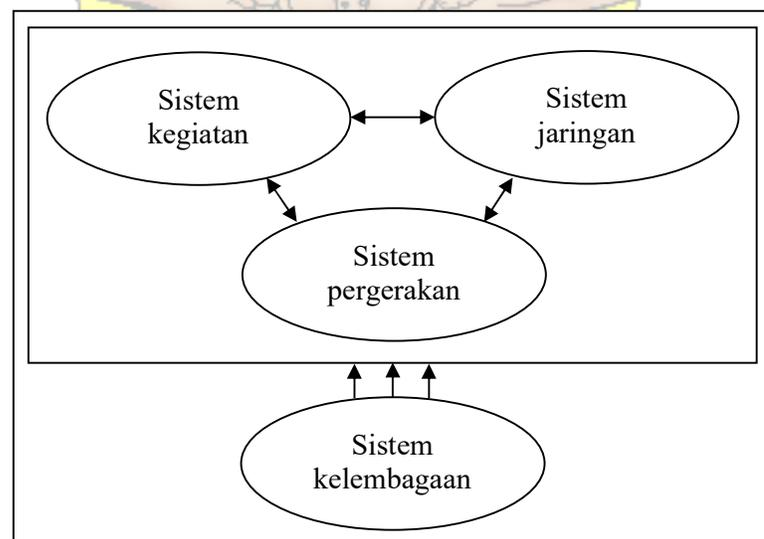
Gambar 2.2 Keterkaitan antar subsistem transportasi
