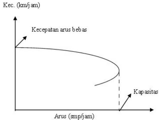
Gambar 2.3 Bentuk umum hubungan kecepatan dan arus
