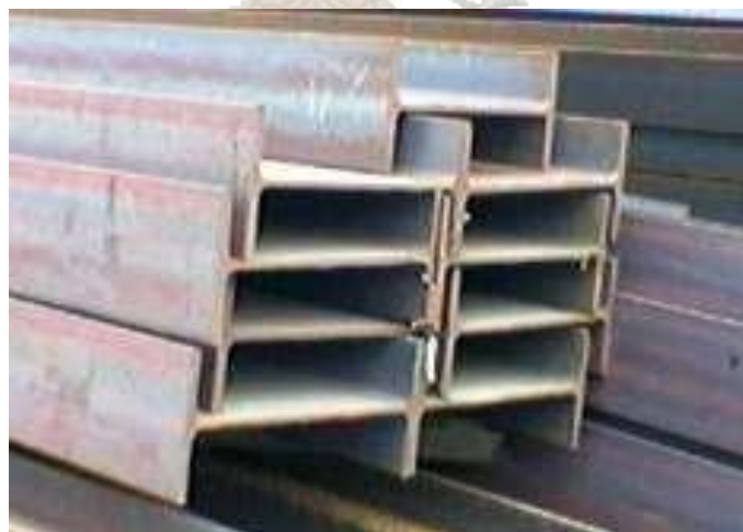
Gambar 2.15 Profil WF baja Sumber: 99.com, 2020
